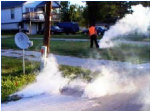
Il n'est pas rare de voir des panaches de fumée sortir d'endroits particuliers, tels que des fissures dans les rues ou dans les cours résidentiels pendant les tests de fumée.
