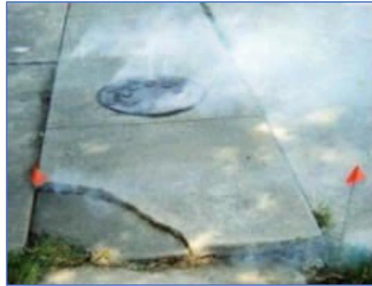
*Des ventilateurs à grande capacité sont utilisés pour pomper la fumée dans un trou d'homme (photo de gauche). Sur la photo de droite, la fumée est poussée dans le système et sort des fissures du trottoir et d'un regard en aval.*
