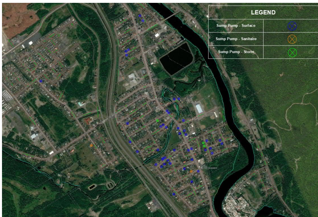
Figure no 5 : Emplacement approximatif des bâtiments avec des pompes de sous-sol
